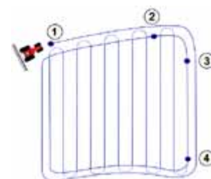
Предварительная обработка разворотных зон по контуру (линия 1-2), с последующей обработкой поля загонками, параллельными базовой прямой (линия 3-4)
