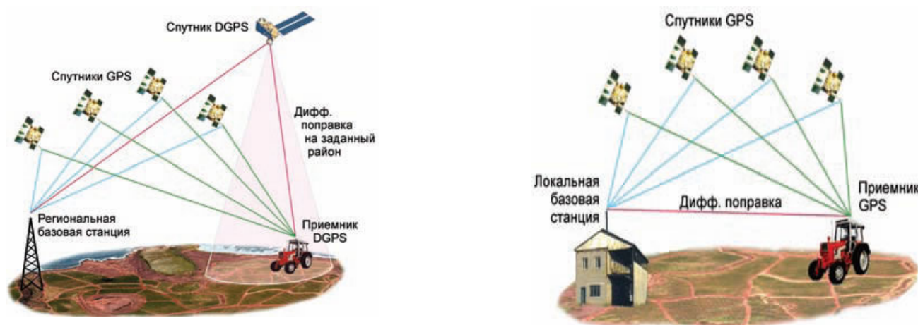
Схемы работы приемника, установленного на тракторе и получающего дифференциальную поправку от спутника DGPS и по радиоканалу от локальной базовой станции.
